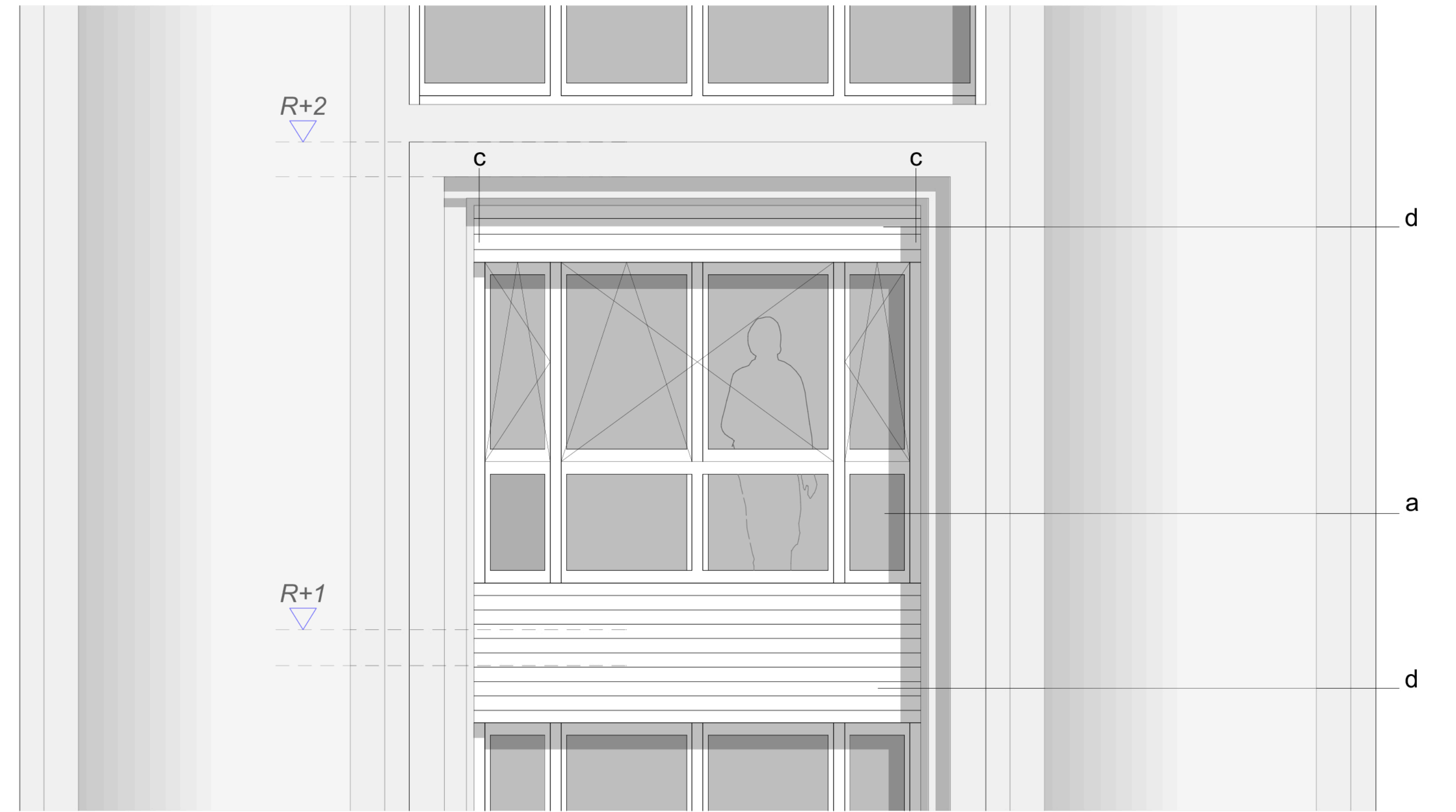
BSO VUE DE FACE - SÉJOUR R+1 SUR HALL COFFRE PERSIENNES SANS MONTANTS
